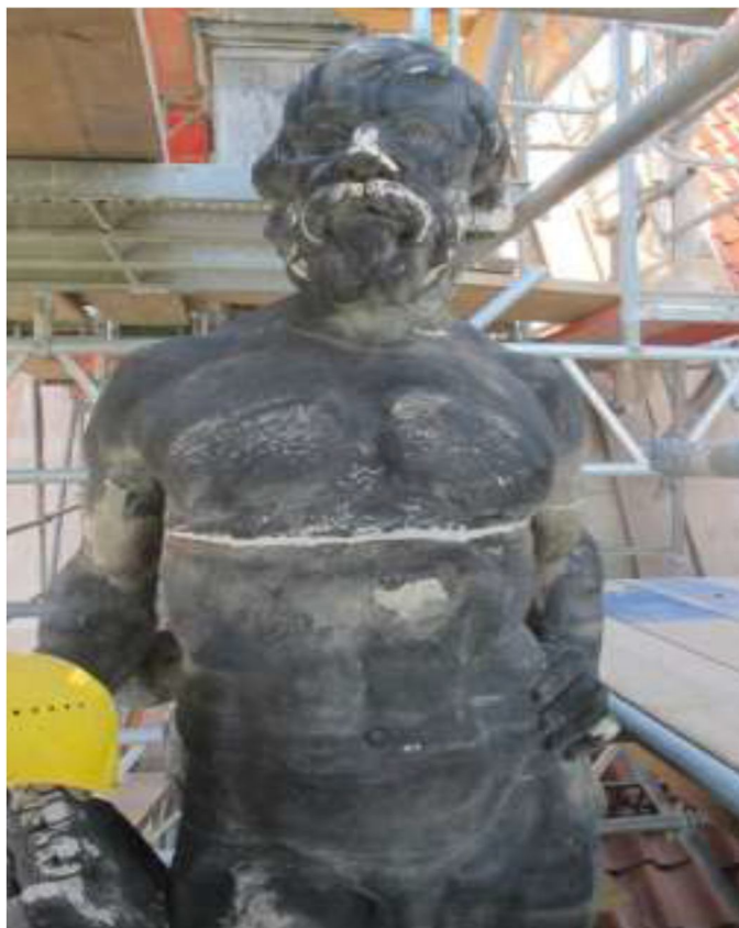
Schadensbild Sandsteinplastik: ungeeignete Ergänzung mit Polymermörtel, Abplatzungen der schwarzen Krusten
