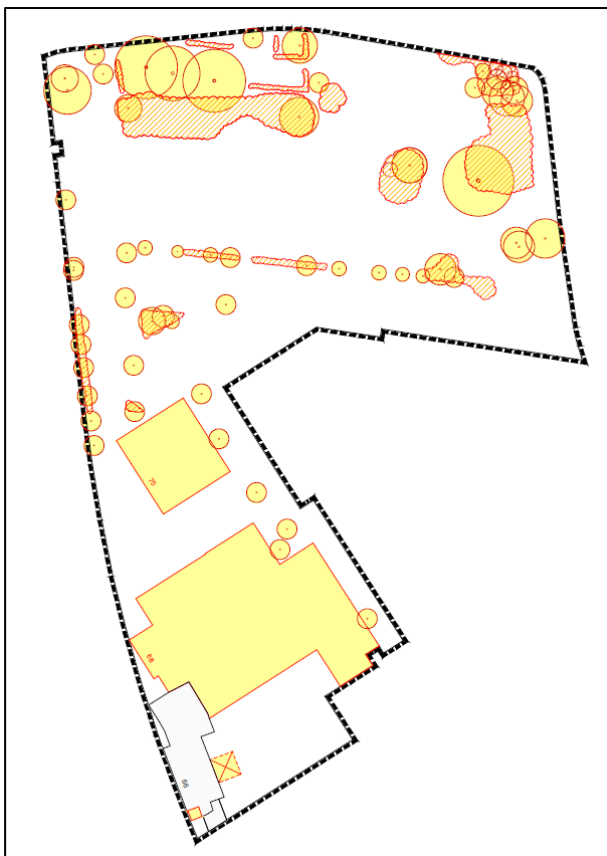
Abb. 13 Übersicht der zu beseitigenden Gehölze und Bauwerke im Vorhabengebiet (unmaßstäbliche Darstellung)
