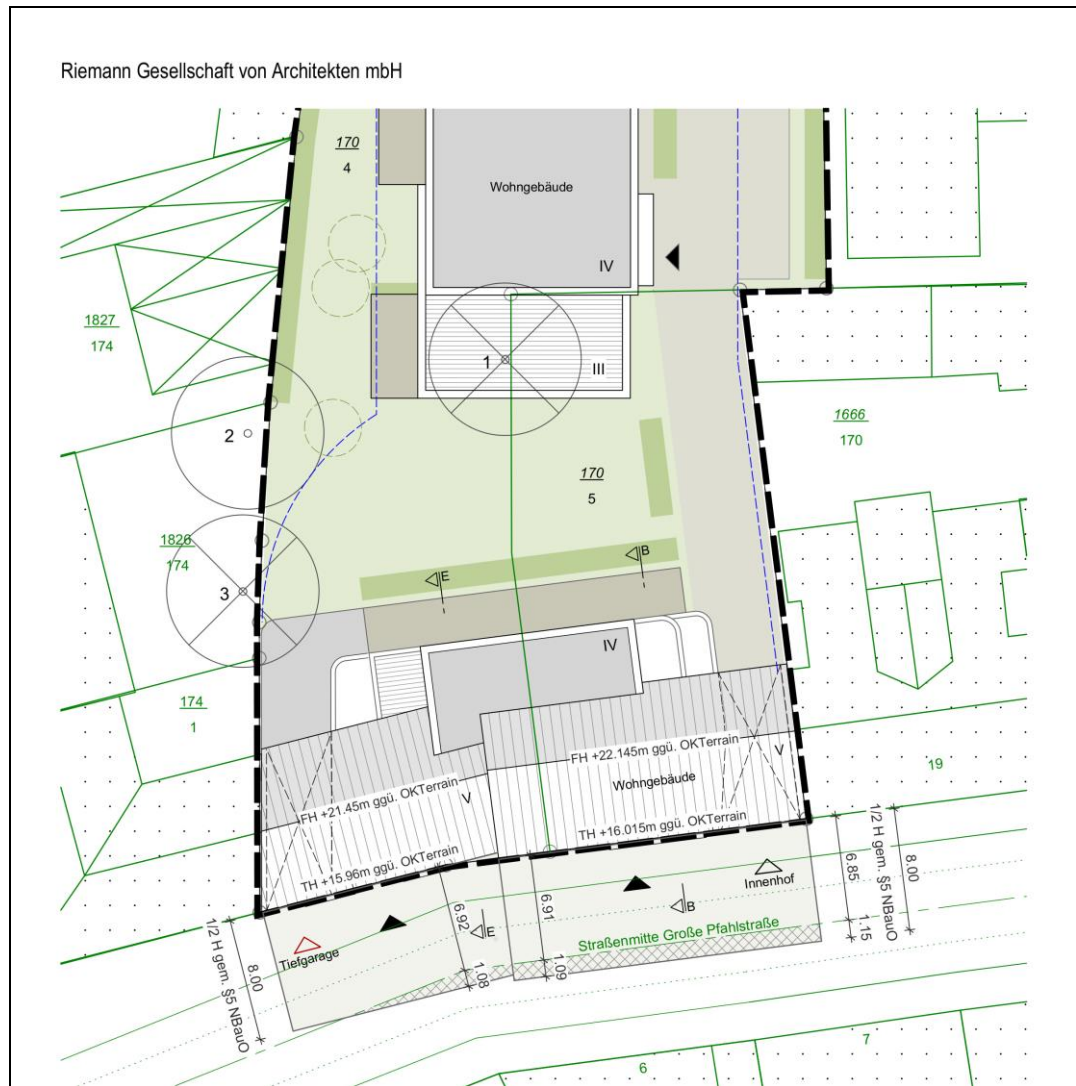
Abbildung 2: Darstellung der Grenzabstände zur Großen Pfahlstraße mit Kennzeichnung der Überschreitung des Grenzabstandes
